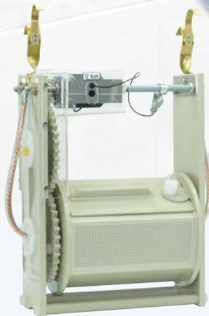
Unsere bewährten **TeMotion**-Motoren mit einem Drehmoment von 15 Nm wurden speziell für die Anwendung in Galvanowerkstätten als Antrieb für Trommeln mit hohem Chargengewicht designt.
