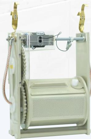
Unsere bewährten **TeMotion**-Motoren mit einem Drehmoment von 15 Nm wurden speziell für die Anwendung in Galvanowerkstätten als Antrieb für Trommeln mit hohem Chargengewicht design.
