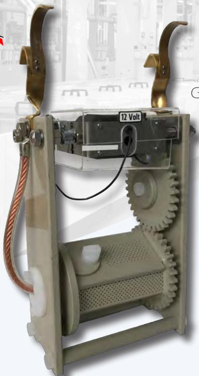
Unsere Galvanisiertrommelaggregate vom Typ T41 werden aus Polypropylen oder alternativ aus Plexiglas in Deutschland hergestellt. Ihr Aufbau ist das Resultat jahrelanger Erfahrung in der Produktion von Trommelaggregaten für die Galvanikwerkstatt.
